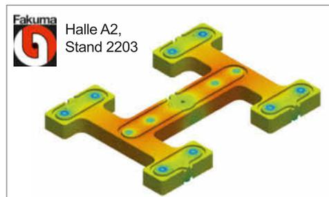
KI-unterstützte thermische Simulation als kostenfreier Standard für jedes Verteilersystem.
