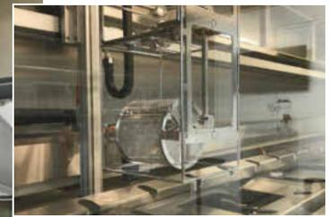
Die Anlage erfüllt die hohen Sauberkeitsanforderungen bei der Endreinigung der Linsen. Das spezielle Transportgestell kann bei Trockenprozessen mit bis zu  $1500 \text{ min}^{-1}$  um die vertikale Achse gedreht werden
