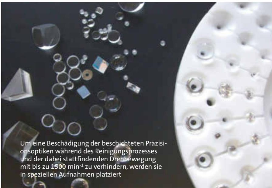
Um eine Beschädigung der beschichteten Präzisionsoptiken während des Reinigungsprozesses und der dabei stattfindenden Drehbewegung mit bis zu  $1500 \text{ min}^{-1}$  zu verhindern, werden sie in speziellen Aufnahmen platziert
