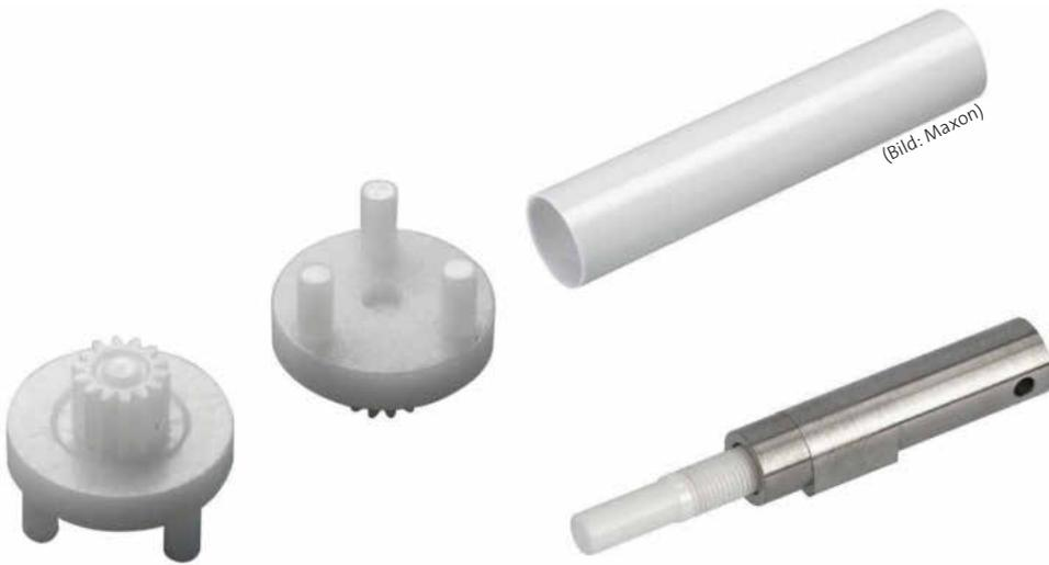
Keramik für die Medizintechnik: Planetenträger für Antriebe in Medikamentenpumpen lassen sich als Spritzgussteil fertigen (links im Bild). Die keramische Isolationshülse (rechts oben) eignet sich für die Endoskopietechnik, die Keramikspindelbaugruppe (rechts unten) kommt in der Orthopädietechnik zum Einsatz
