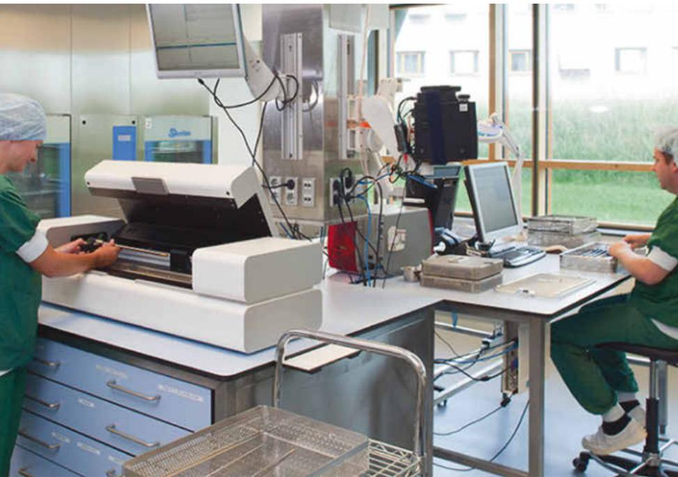
Der Endoskoptester Scope Control wurde entwickelt, um die Qualität von starren Endoskopen zu überprüfen. Der Validierungs- und Qualitätsprüfungsprozess dieser Technologie entspricht dem globalen Standard für Gerätesicherheit
