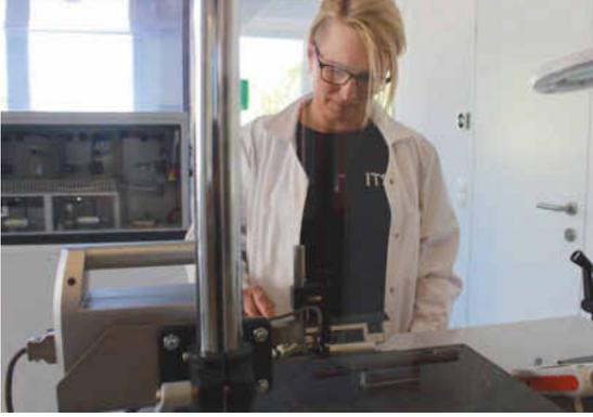
Die mobile Oberflächenmessung führen die Mitarbeiter bei ITS direkt in der Fertigung durch
