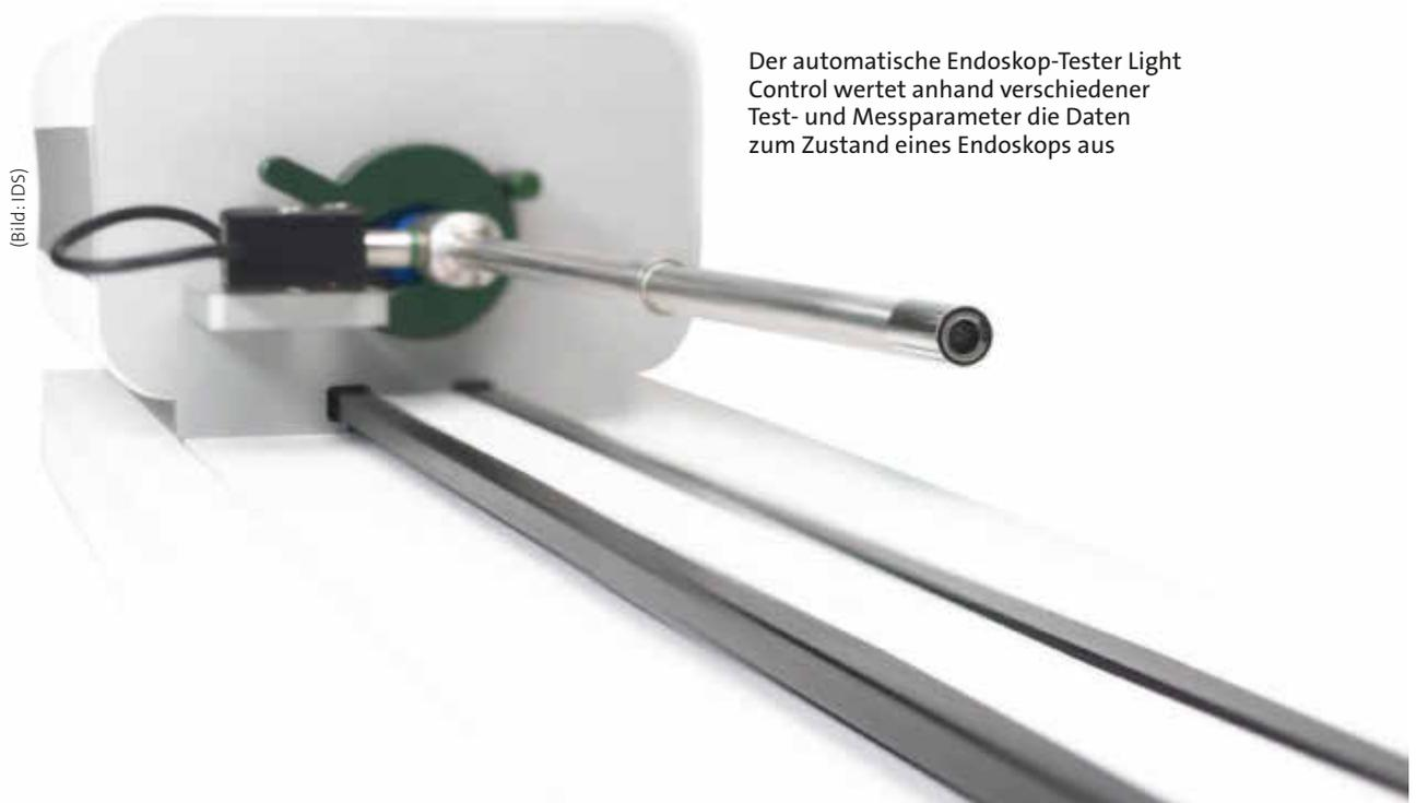
Der automatische Endoskop-Tester Light Control wertet anhand verschiedener Test- und Messparameter die Daten zum Zustand eines Endoskops aus
